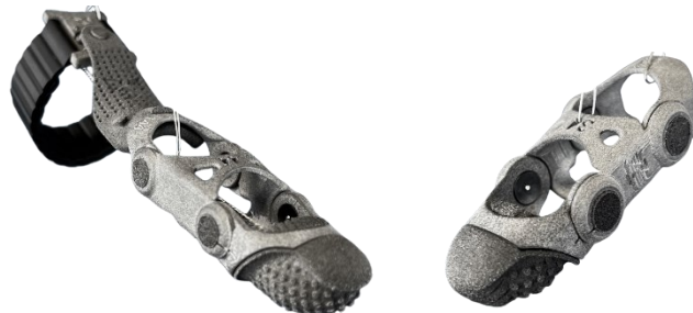
Abbildung 2. Die beiden Versionen des ARTUS Finger-Exoskeletts. Links: die ARTUS-Version für den Daumen. Rechts: Die ARTUS-Version für die langen Finger (Zeige- bis Kleinfinger).
