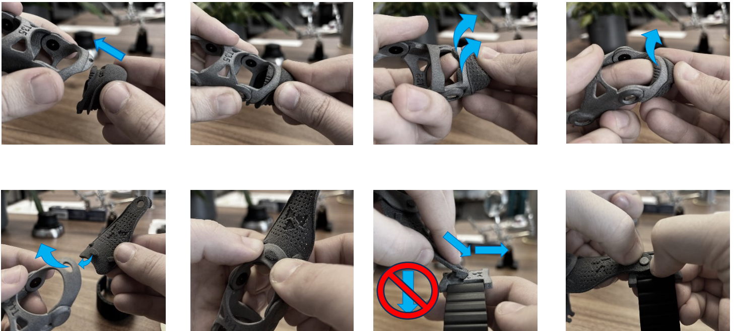
Abbildung 3. Oben: Abfolge (von links nach rechts), um ein beliebiges DigiSkin-Element in die Exoskelett-Spitze einzubauen. Unten: Abfolge (von links nach rechts), um das Handgelenkszubehör zusammenzubauen (nur Dauemenvariante (AT)).
