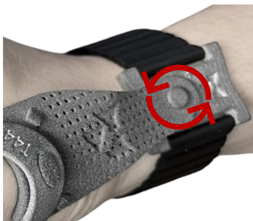
Abbildung 6. Der asymmetrische Handgelenkanschluss ermöglicht die Einstellung des Abstands zwischen Handgelenk und Exoskelett. Er ist nützlich, um die Reichweite der Spitze, die Beweglichkeit des Handgelenks und den Komfort zu erhöhen..
